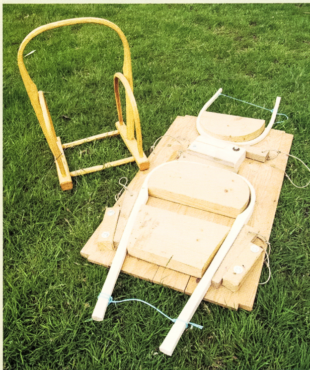
Ovan. Ett exempel på mall för böjda bakben. Benens nedre del fästs med kilar. Topparna spänns ihop med t.ex. tvingar och kan sedan låsas med rep eller band.
