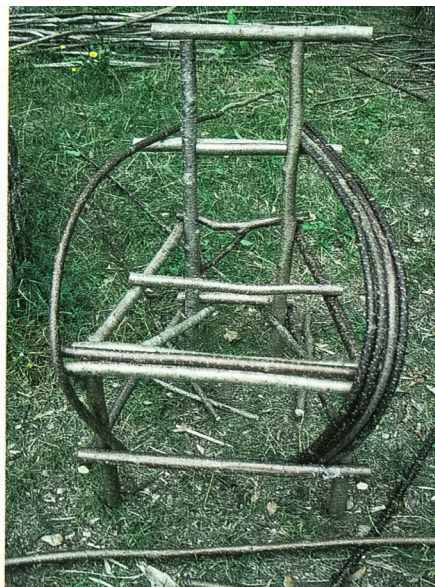
D. Rotänden på slänorna för armstöden spikas fast bakom tvärlån fram. De böjs bakåt och fästs mot mittpinnen bak.
