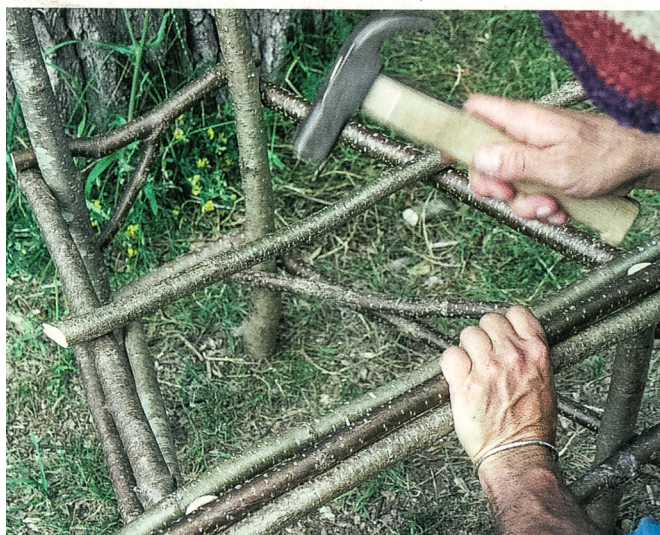
C. Sätt fast pinnar som sitsen kan vila på. En pinne mot frambenens insida, en mot bakbenens insida och en mitt emellan.
